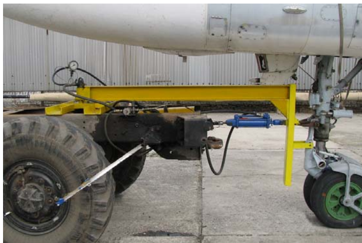
Рис. Тягач-буксировщик, оборудованный автоматическим догружающим тягово-сцепным устройством
