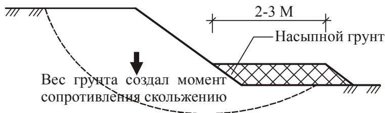
Рис. 1. Метод отсыпки бермы у подножия склона земляного полотна.
